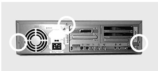
Jetzt können Sie den Gehäusedeckel durch einen leichten Ruck nach hinten lösen. Ziehen Sie die Gehäuseabdeckung durch vorsichtiges Bewegen nach hinten und oben von dem Rechner ab (Abbildung 3). Sollten Sie beim Abnehmen des Gehäusedeckels Widerstand verspüren, so wenden Sie bitte keine Gewalt an, sondern sehen Sie unter den Deckel, ob sich eventuell ein Kabel oder ähnliches an der Abdeckung verfangen hat.
